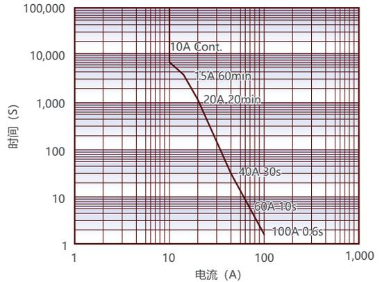
备注: 以上数据在环境温度为85℃, 导线截面积≥2.5mm<sup>2</sup>条件下测得。数据仅作参考, 请勿直接用于选择熔断器。
