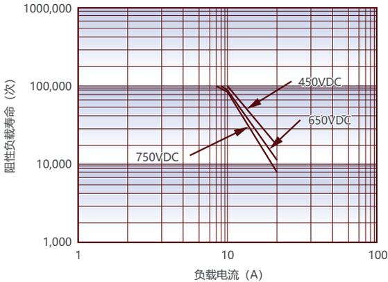
备注: 额定电气寿命次数基于阻性负载, 在接通/断开下测试, 接通0.6S, 断开5.4S。
